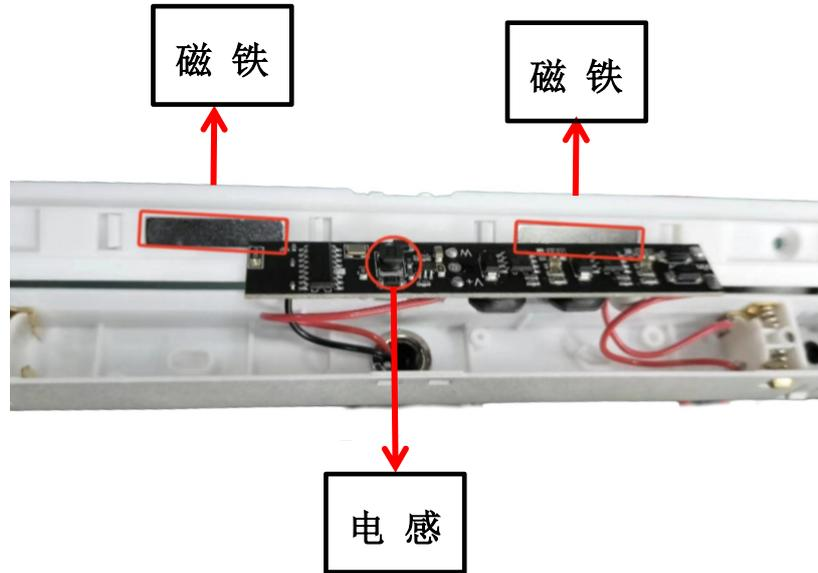
**注：**磁吸驱动正面的贴片电感和磁吸壳体内的磁铁距离太近，影响电路的稳定工作，在安装时一定要把电感远离壳内的磁吸！
