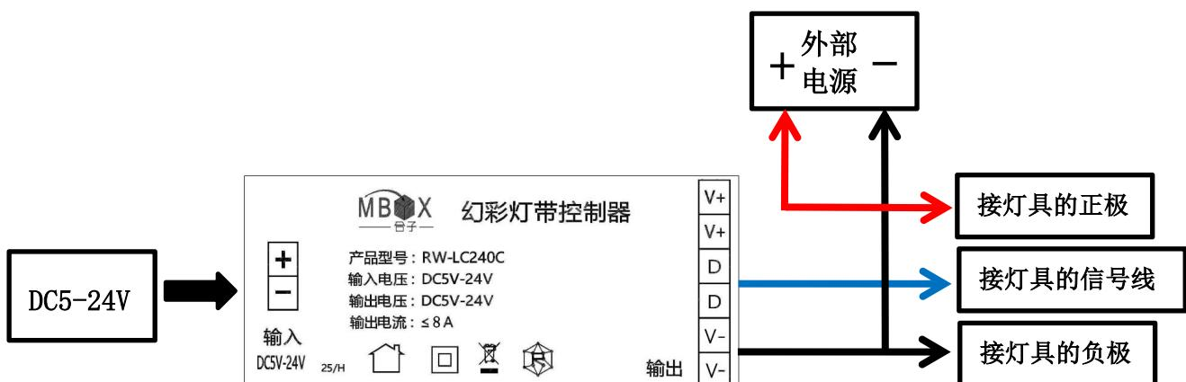
RW-LC240C 接 “外部电源+” “外部电源-” “输出 D” “输出 V-”
